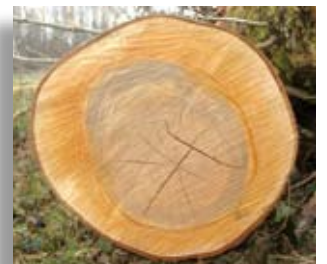
Après séchage, l'aubier sera usiné de façon identique au bois de cœur
