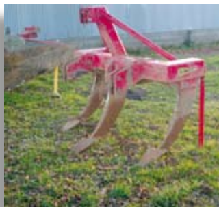
La sous-soleuse décompacte le sol en profondeur
